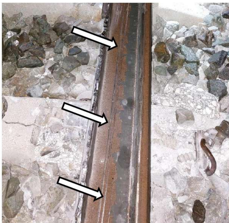
4: Carril tumbado hacia el exterior, tras el punto de rotura. Se observan en el alma del carril huellas de paso de ruedas del tren.
