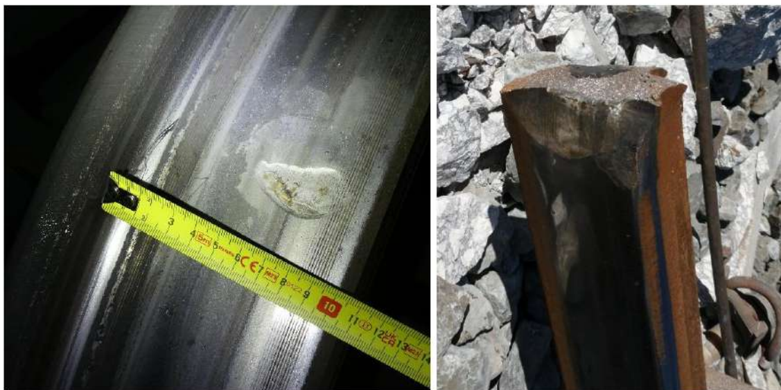
1: Muecas presentes en la rueda derecha del eje 13 del tren de Iryo (coche 4, primer eje del primer bogie) y posible punto de colisión con la cabeza del carril.
