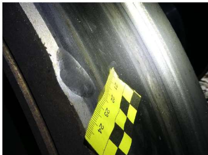
3: Muesca presente en la rueda derecha del eje 19 del tren de Iryo (coche 5, primera rueda, segundo bogie)
